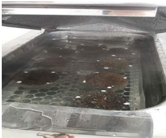
Figura 4 – Corpo de prova imerso em água
