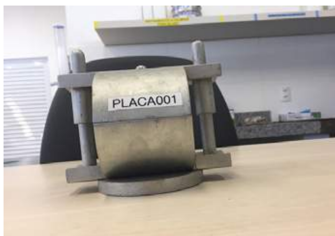
Figura 5 – Molde para determinação da estabilidade e fluência.
