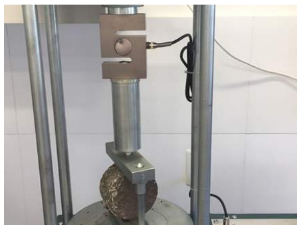
Figura 11 – Molde com o corpo de prova na prensa Marshall.
