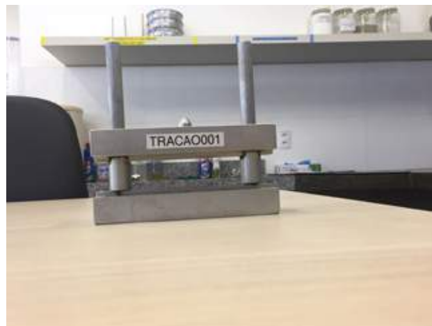
Figura 10 – Molde para determinação da resistência por tração diametral.
