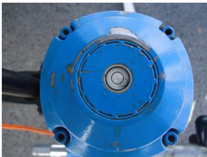
Figura 22 – Sonda rotativa desalinhada.
