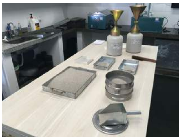
Figura 2.5 - Determinação da massa específica da areia
