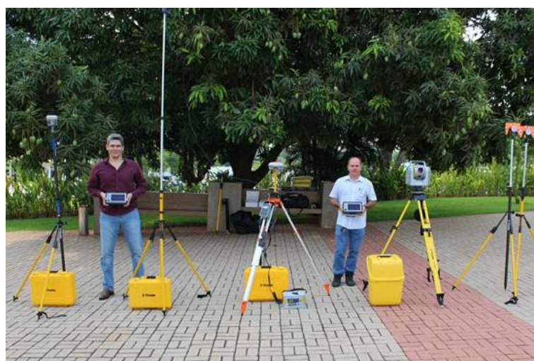
Figura 2 – Estação Total Robotizada com scanner (equipamentos de topografia)
