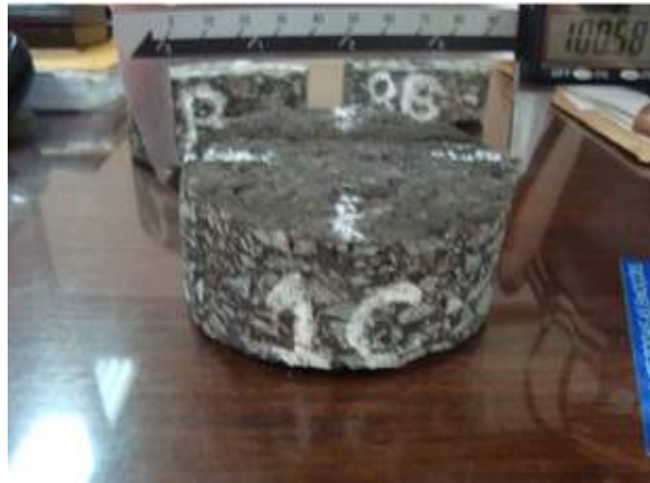
Figura 9 – Diâmetro do corpo de prova (D).
